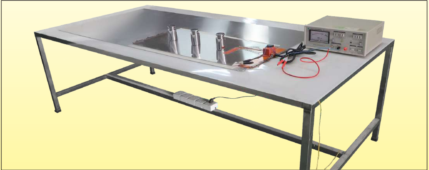
Прибор для измерения сопротивления изоляции. Измеренные значения всегда больше 0,1 ГОм
